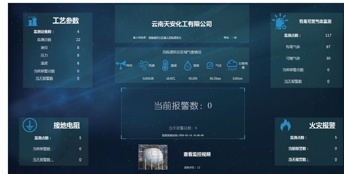
公司危化品重大危险源实时监测与预警系统
